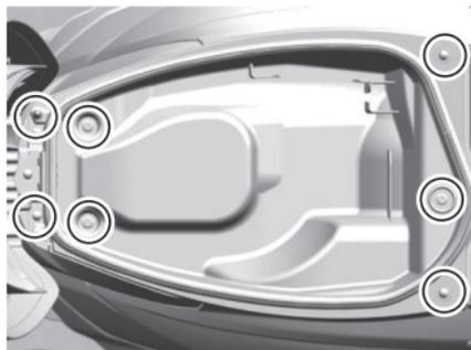
4. スクリュ（4箇所）を外します。フック（2箇所）を外し、エアクリーナキャップ①を取り外します。
