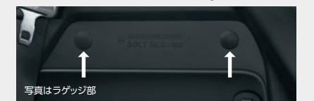
ユーティリティーナット ナットのキャップを外せば、④ユーティリティーカラーリングフックが取り付けできます。
