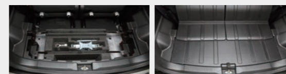
② スペアタイヤ固定キットを装着した状態 ③ ラゲッジボードを閉じた状態
