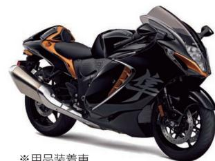
「Hayabusa」は、初代から続く開発コンセプト「Ultimate Sport（究極のスポーツバイク）」のもと、高い空力特性を持つ独特のデザインや優れた走行性能をさらに進化させました。1,340cc直列4気筒エンジンは、電子制御スロットルの採用や吸排気の機構変更などにより、低中速域における出力とトルクを向上しながら、空力特性の追求によって高速性能を落とすことなく、新しい排ガス規制「ユーロ5」に対応しました（欧州仕様車）。
