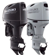
DF140BG/115BG 世界初※ 4ストローク140馬力・115馬力 クラスで電子スロットル&シフトを採用 ※2021年1月現在、スズキ調べ。
