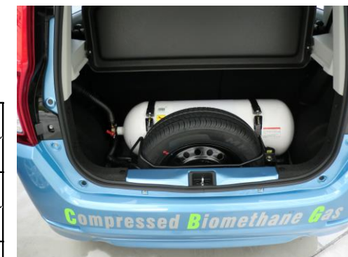
ワゴンRのトランクに搭載のCNGタンク
