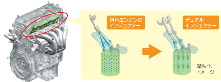
デュアルインジェクターで燃料を霧状に微粒化し噴射。燃料が燃えやすくなることで熱効率が向上し、ノッキングも抑制します。
