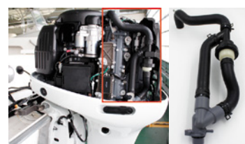
マイクロプラスチック回収装置を取り付けた船外機
