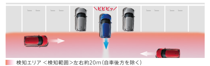
検知エリア <検知範囲>左右約20m(自車後方を除く)
