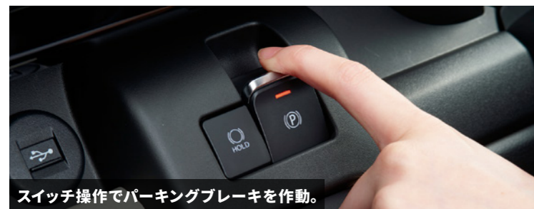
スイッチ操作でパーキングブレーキを作動。
