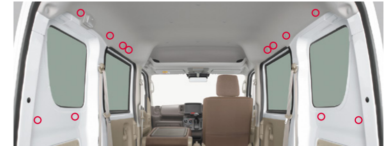
*ユーティリティーナットは、JOINターボ・JOINは8ヶ所、PC・PAリミテッド・PAは12ヶ所設けております。
