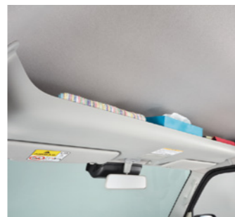
13 オーバーヘッドシェルフ (ハイルーフ車) *耐荷重: 左右、中央の各位置でそれぞれ500g
