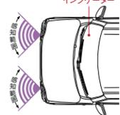
●フロントパーキングセンサーは運転の補助として障害物の接近をブザー音で知らせるもので、ドライバーの注意義務を軽減するものではありません。●全ての障害物に対して作動するわけではありません。周囲の安全を直接ミラーや目視で確認しながら運転してください。●車両中央部分はセンサーが感知できません。また、細いポールなどには反応しない場合があります。
