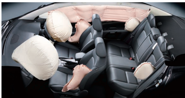
エアバッグ膨張イメージ写真
