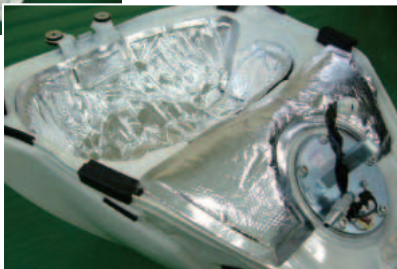
ガソリタンク内側の吸音材 (銀色のシートが吸音材)
