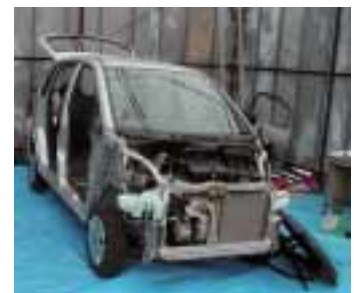
手作業での解体実験 (MRワゴン)
