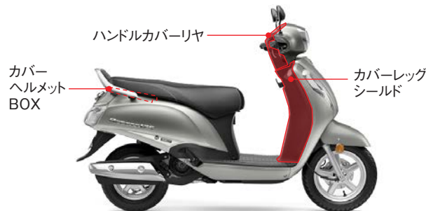
外装樹脂3部品に材料着色リサイクルPP樹脂材を採用
