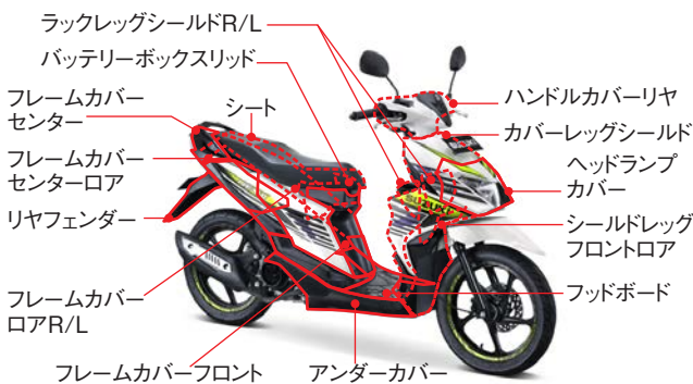
外装樹脂15部品及びシート底板上にPP材を採用
