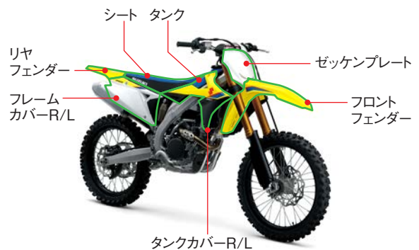
外装樹脂の80%にあたる8部品及びシート底板上にPP材を採用
