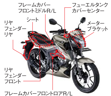
外装樹脂7部品及びシート底板上にPP材を採用
