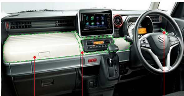
アッパーボックス センターアッパーパネル ドライバーアッパーパネル
