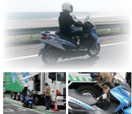
浜松水素ステーション(移動式)での水素充填(2017年3月から実際の運用開始)
