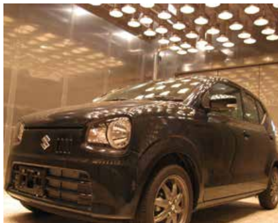
新たに導入した恒温恒湿槽での車室内VOC測定の様子
